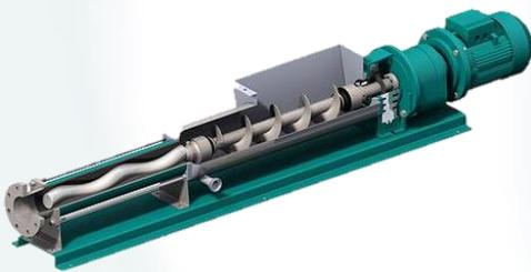
Tremonha aumentada para fluidos com elevado conteúdo de sólidos ou fibras. Muito usadas em conjunto com filtros de prensa ou de banda. Tremonha e parafuso sem-fim asseguram máxima eficiência e fiabilidade. Podem trabalhar com líquidos com viscosidades superiores a 10.000 cPs.
